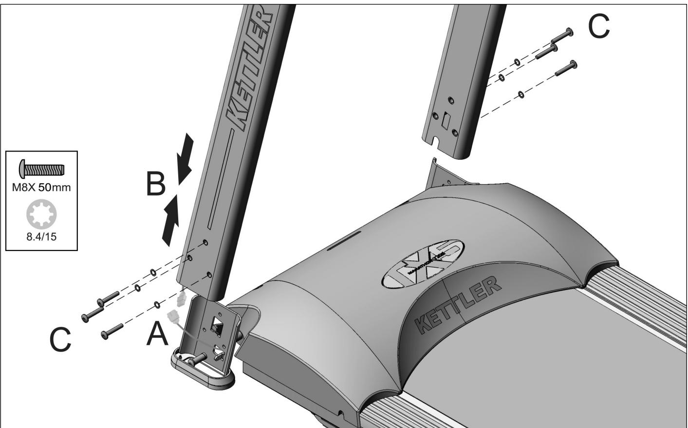
Schrauben zuerst nur lose anziehen, nach Schritt 2 festziehen.
